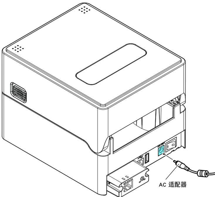
2. 将 AC 电缆线的插头插入电源插座。
