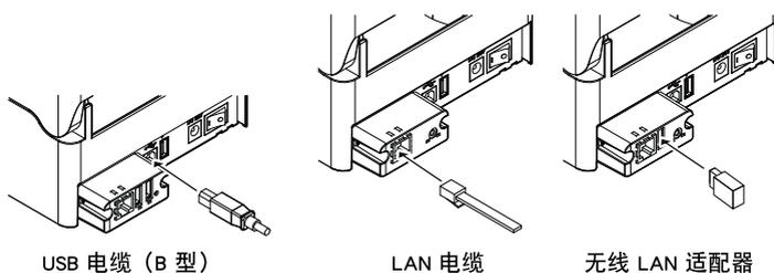
3. 将电缆的另一端正确插入主机的适用接口端。
