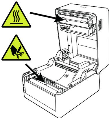
这些标签表示打印头温度高，触摸会导致灼伤。如果在纸盖打开的情况下触摸自动切纸器和手动切纸器可能会导致手部割伤。
