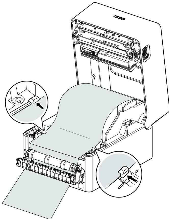
此时，请确认下传感器上没有标签或标签没有越过下传感器（只有衬纸越过下传感器）。
