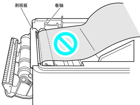
6. 进一步向下拉动衬纸，让衬纸展开距离剥纸器盖至少 7 cm (图示 A)。
