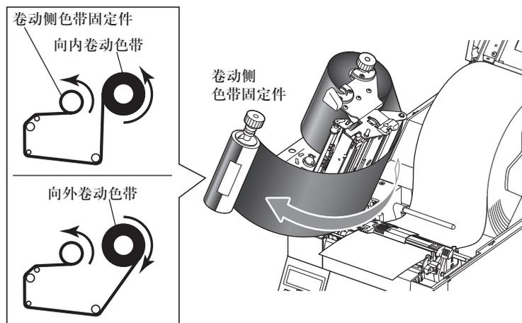
5. 将已安装好纸芯的色带固定件安装进色带驱动单元，然后按箭头所示方向转动色带固定件以张紧色带及消除褶皱。
