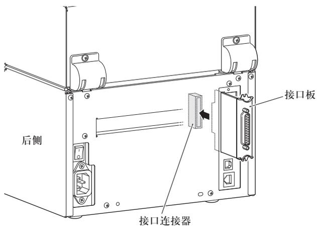
3. 使用拆下的螺丝（2 个）将接口固定到打印机上。
