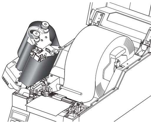
6. 按蓝头关闭按钮以降低并锁定蓝头单元。请务必始终通过按蓝头关闭按钮锁定蓝头单元。如果色带出现褶皱，按住送纸键直到褶皱消失。如果褶皱没有消失或出现滑动，请进行色带平衡调节和色带张力调节。请参见“第三章 打印机调节”了解这些调节方法。
