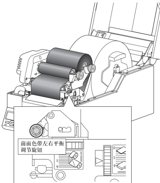
1. 从正面查看色带，检查送纸侧色带和后侧色带导板轴之间存在松动的一侧（调节旋钮侧/调节旋钮的对侧）。
