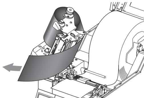
4. 使用色带的粘合端或一些胶带将已拉出的色带固定到装有纸芯的色带固定件，然后将色带缠绕在色带固定件上。
