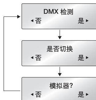
如果选择“是”，打印机将重启并自动切换到 Datamax® 模拟器 (DM4/DMI/DPP)。如果选择“否”，打印机将返回到准备就绪状态。
