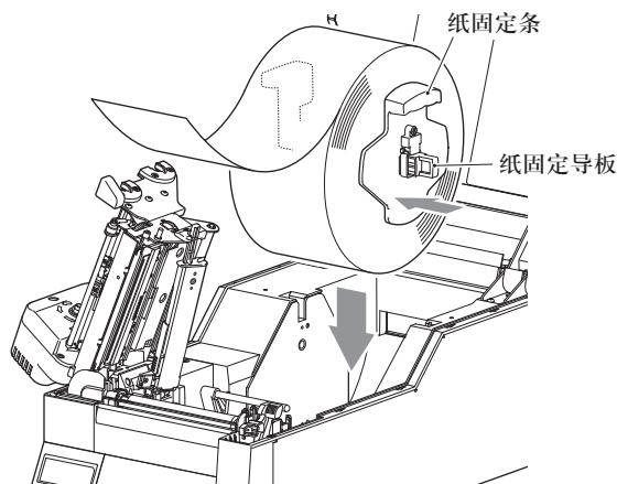
3. 面对打印机的前侧，设置纸张，使纸固定导板位于纸的右侧。
