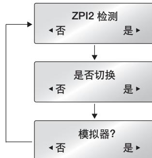
如果选择“是”，打印机将重启并自动切换到 ZPI2 模拟。如果选择“否”，打印机将返回到准备就绪状态。
