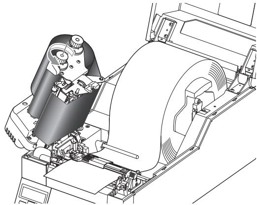
6. 按蓝头关闭按钮以降低并锁定蓝头单元。请务必始终通过按蓝头关闭按钮锁定蓝头单元。如果色带出现褶皱，按住送纸键直到褶皱消失。如果褶皱没有消失或出现滑动，请进行色带平衡调节和色带张力调节。请参见“第三章 打印机调节”了解这些调节方法。
