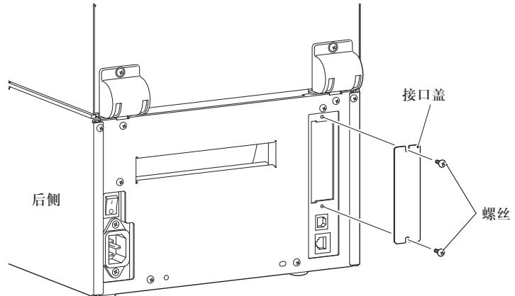
2. 将接口插入槽内，然后连接到打印机内的接口连接器。
