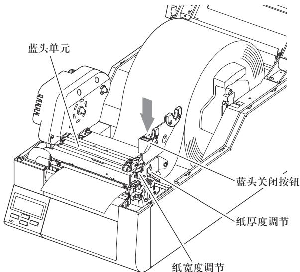
10. 按送纸键输送纸。其将在下个打印开始位置停止。
