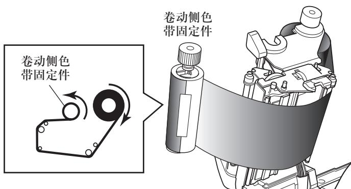
6. 将已安装好纸芯的色带固定件安装进色带驱动单元，然后按箭头所示方向转动色带固定件以张紧色带及消除褶皱。
