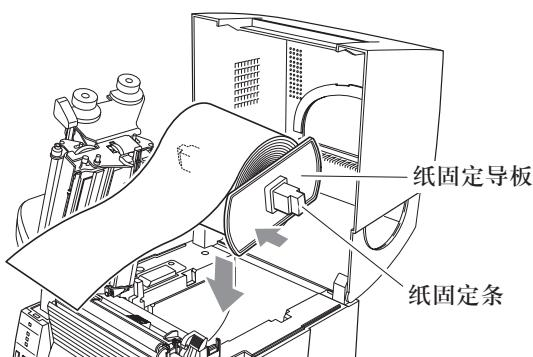
4. 如上图所示，将纸卷和纸固定件装入打印机中。建议向前拉出一段纸并穿过机构，以备后续定位。
