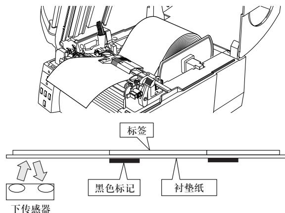
4. 如果在按住设定 / 再印刷键时按下再松开暂停键，印刷指示灯会熄灭，设定指示灯从亮起变为快速闪烁后，即开始送纸，并自动调节传感器。
