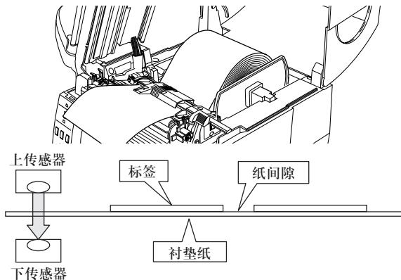
5. 如果在按住设定 / 再印刷键时按下再松开暂停键，印刷指示灯会熄灭，在设定指示灯从亮起变为快速闪烁后，即开始送纸，并自动调节传感器。
