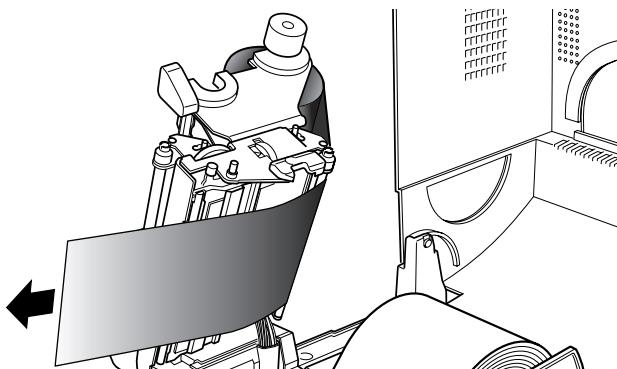
5. 从已装有纸芯的色带固定件上拉出色带，使用胶带等将其固定后缠绕在色带固定件上。
