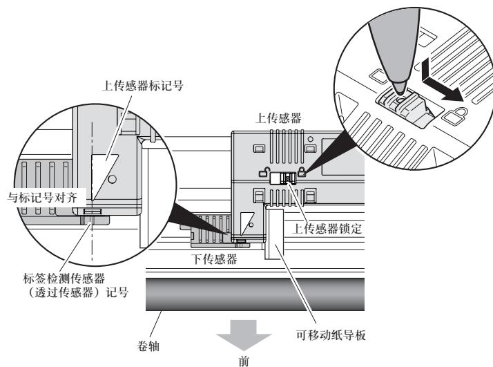
当使用 4 英寸宽的纸时，请将上传感器和下传感器全部靠右（大蓝头开杆一侧）定位。
