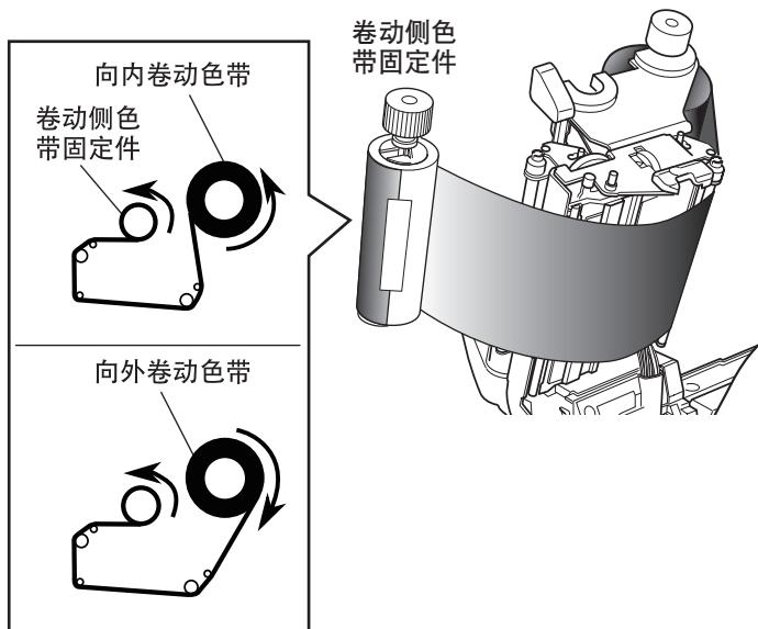
6. 将已安装好纸芯的色带固定件安装进色带驱动单元，然后按箭头所示方向转动色带固定件以张紧色带及消除褶皱。
