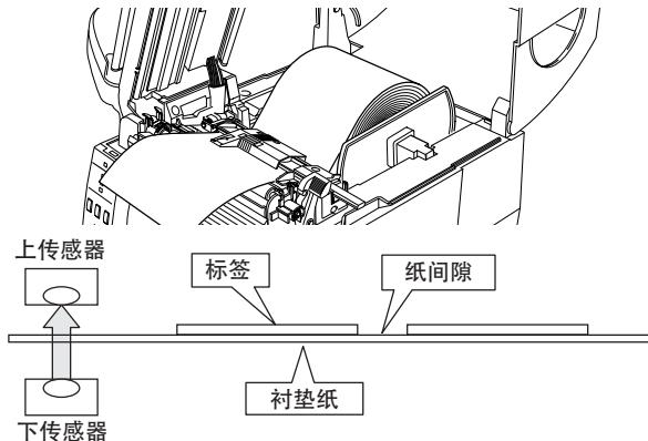
5. 如果在按下设定 / 再印刷键的同时按下并松开暂停键，则印刷指示灯熄灭，在设定指示灯从亮起变为闪烁后，开始进纸并将自动调节传感器。
