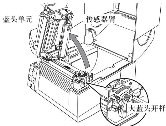
2. 使用纸张即将用完传感器时，应设置传感器位置。有关如何进行设置，请参阅“设定纸张即将用完传感器”。(产品出厂时，这些设置为关闭状态。)
