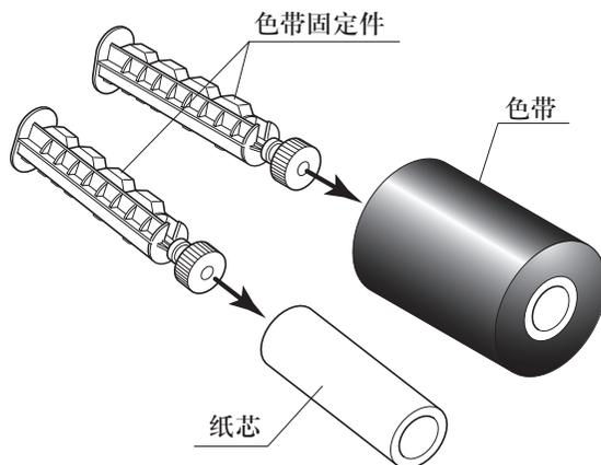
3. 将新的色带以及固定件装进后色带驱动单元。使色带驱动齿轮机构上的花键与色带固定件的尾端吻合。
