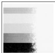
左侧是第二个范例，其显示的是设定不正确的“纸宽度调节”。对于 6 英寸或 150mm 宽的纸，调节器应设于蓝色拨盘上的“9”位置。以上设定针对一般的标签纸，不一定适用于特殊纸。
