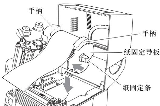
4. 如上图所示，将纸卷和纸固定件装入打印机中。建议向前拉出一段纸并穿过机构，以备后续定位。抬起纸时，应同时使用纸固定条上方两侧的手柄。
