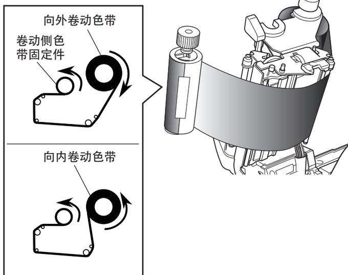
6. 将已安装好纸芯的色带固定件安装进色带驱动单元，然后按箭头所示方向转动色带固定件以张紧色带及消除褶皱。
