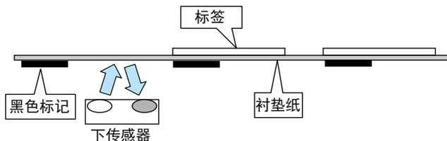
3. 进行传感器调节。通过菜单画面的“测试&机器信息” -> “测试模式” -> “传感器调节”选择“反射”后，按画面下部的“OK”按钮。按显示画面中的“开始”按钮，自动调节传感器。
