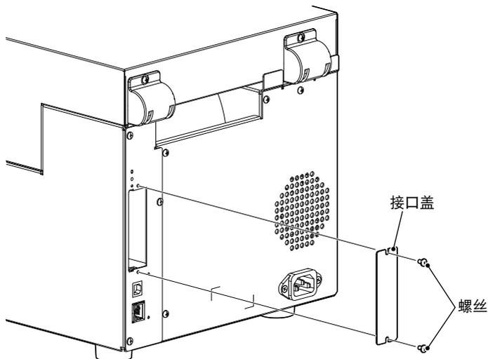
2. 将接口插入槽内，然后连接到打印机内的接口连接器。
