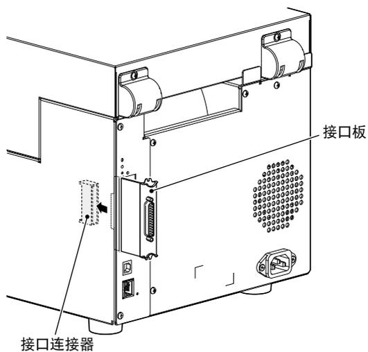
3. 使用拆下的螺丝（2 个）将接口固定到打印机上。
