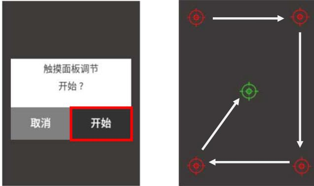
轻触全部目标后，若正确完成校准，将显示以下画面。至此，完成触摸面板校准。
