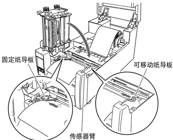
7. 将打印头降低至关闭位置。用力按打印头关闭按钮锁定打印头。只有当听到“喀哒”一声，打印头才被正确锁定。将其与已放置的纸的宽度对齐，然后再设定纸宽度和纸厚度调节拨盘。请参见“4. 打印机调节”。
