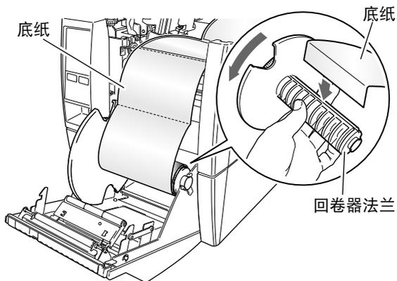
5. 检查并确保底纸单元正确地设置在剥离辊中，然后关闭回卷器盖。
