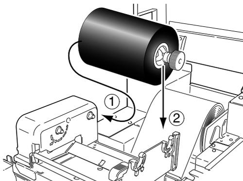
3. 推动大尺寸蓝色打印头开杆松开打印头。从打印头底部拉出色带至色带卷动侧。
