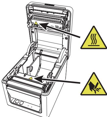
该标签旨在提醒注意：即打印头“温度高”，请勿触碰，否则可能会烫伤；纸盖打开时，请勿触碰自动切纸刀，否则可能导致割伤。
