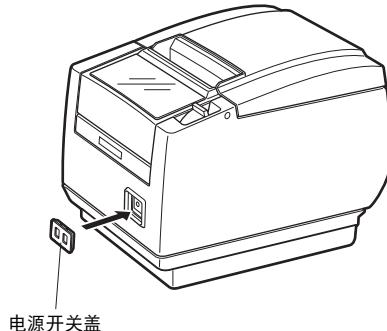
将螺丝刀或其他尖利物体放入电源开关盖槽内，将其拆下。
