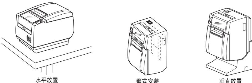
改变打印纸接近耗尽感应器设置，便于垂直和壁式安装。（打印纸接近耗尽感应器的出厂设定适合水平安装。）
