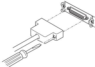
3. 将另一端接头牢牢插入主机的连接端口中。
