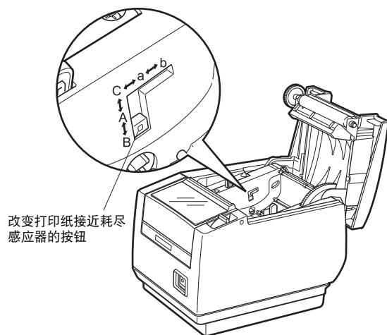
(“A”和“B”适用于水平安装，而“a”和“b”则适用于垂直或墙壁安装。)
