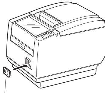
将螺丝刀或其他尖利物放入电源开关盖槽内，将其拆下。
