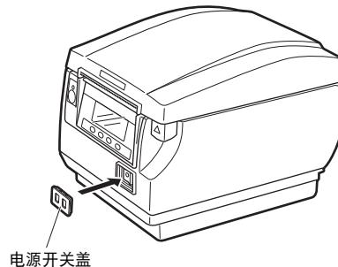
将螺丝刀或其他尖利物体放入电源开关盖槽内，将其拆下。
